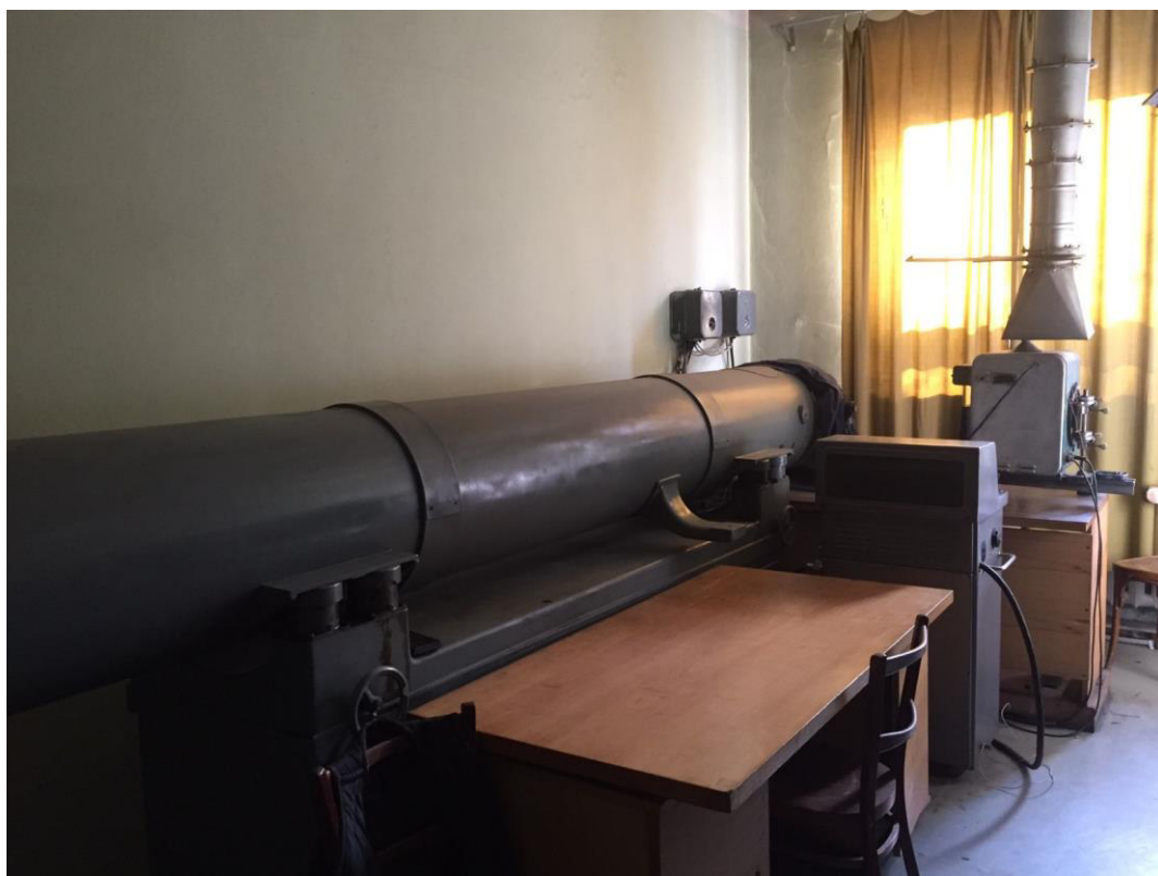
Сурет 8 – ДФС– 3 спектрографы
